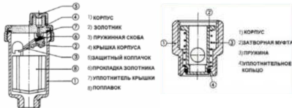
Воздухоотводчик состоит из латунного корпуса 1, внутри которого свободно перемещается полый полипропиленовый поплавок 8.
