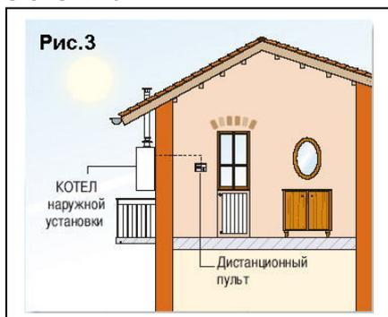
Несомненный интерес у потребителей вызовут модификации настенных котлов **для наружной (уличной) установки (рис.3)**, в том числе встраиваемые (рис.4). Управление и регулировка таких котлов производится с помощью дистанционного пульта управления. Встраиваемые в нишу здания котлы могут иметь верхнее, боковое или тыльное подключение к дымовой трубе, а также имеют возможность нижнего и тыльного подключения гидравлических сетей.
