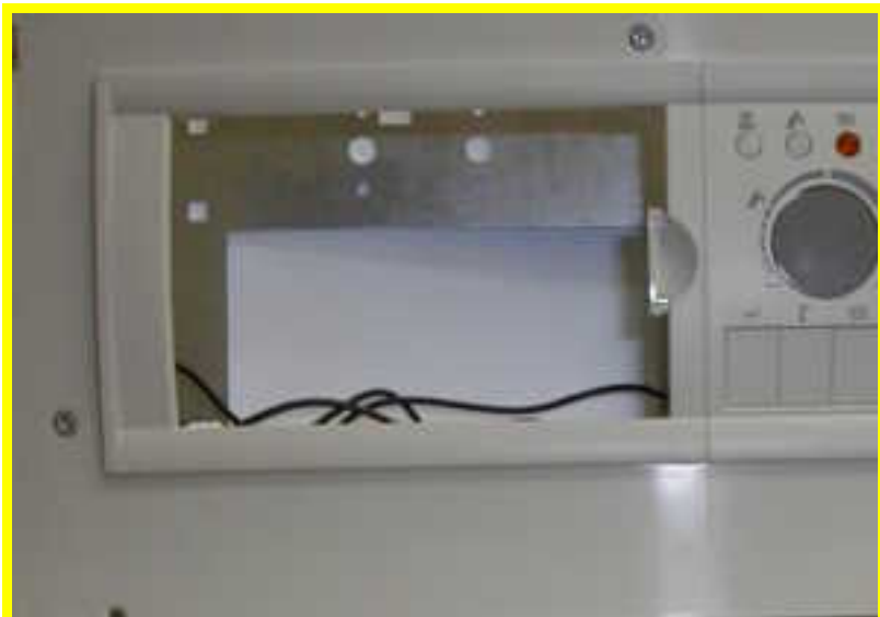
Рис. 5а и 5б (ALTAIR – DRAGO): Удалить пластмассовую часть, сломав опорные перегородки.
