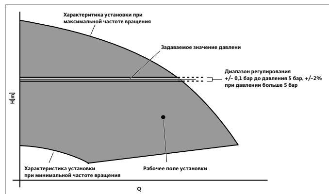
Работа Vario-регулятора VR-1
